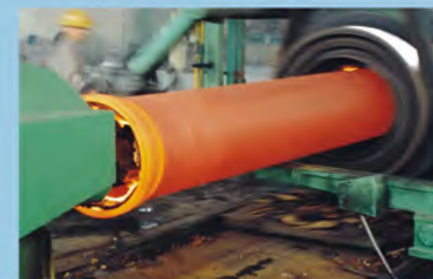
拔管过程 Pipe extracting
