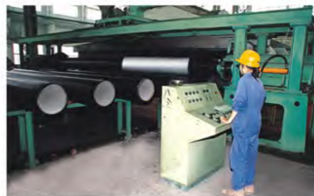
喷沥青 Bitumen coating
