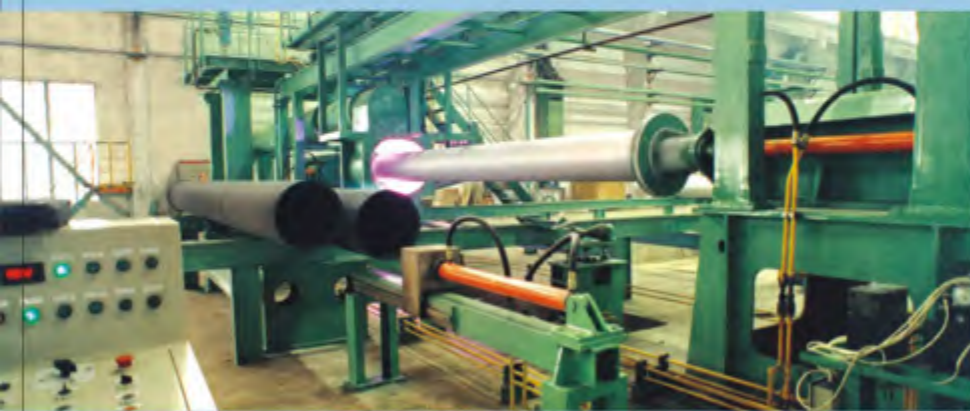
喷锌处理 Zinc spraying
